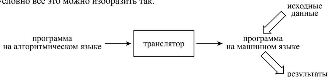
Таким образом, мы вводим в ЭВМ программу на алгоритмическом языке, но на самом деле выполняется не она, а другая программа – эквивалентная ей машинная программа. Так решается проблема с исполнением программ на алгоритмических языках, этих «иностраных» для машины языках.
